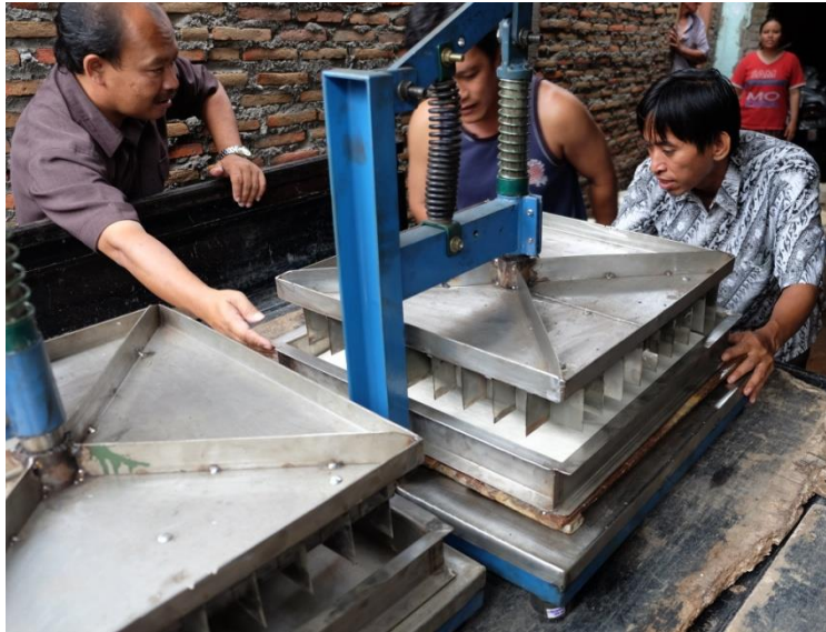
Gambar 4. Proses pemotongan tahu menggunakan alat pemotong tahu
