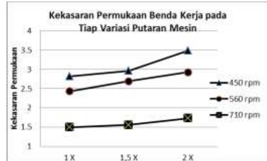
Gambar 2. Kekasaran Permukaan Benda Kerja pada Tiap Variasi kecepatan spindle
