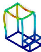
Gambar 13 Hasil simulasi frame dari displacement
