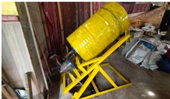
Gambar 1 Mesin mixer sebelumnya
